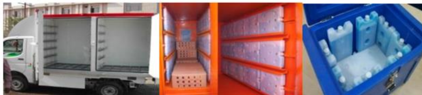
Figura 2.25 - PCM em camião de transporte e arca [37].
