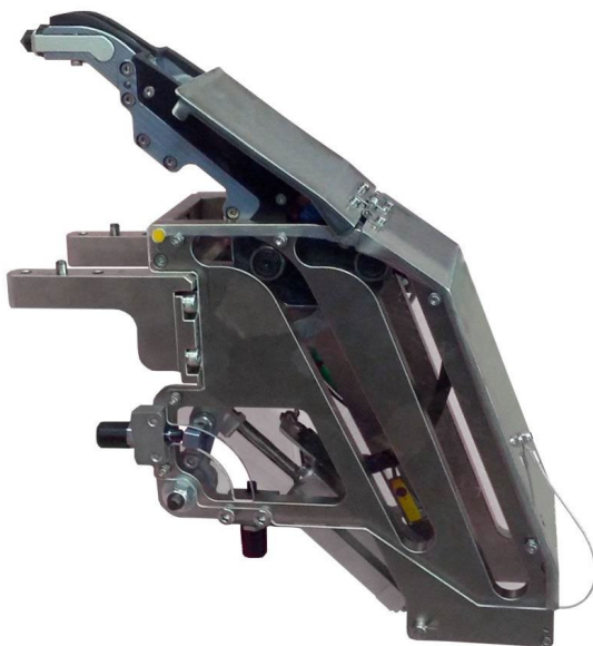
Figura 24 - Aplicador de selante parcialmente estendido [Fonte: Electroimpact (2022) 'Informação Interna']
