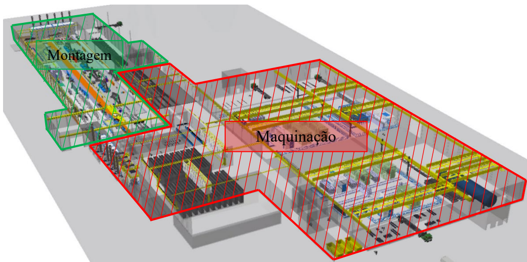
Figura 12 - Planta da Fábrica de Estruturas Metálicas [Fonte: Embraer (2022a) 'Informação Interna']
