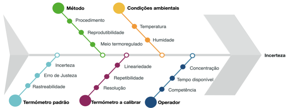
Figura 3.10 Diagrama Ischikawa para fontes de incerteza de medição na calibração dum termómetro.
