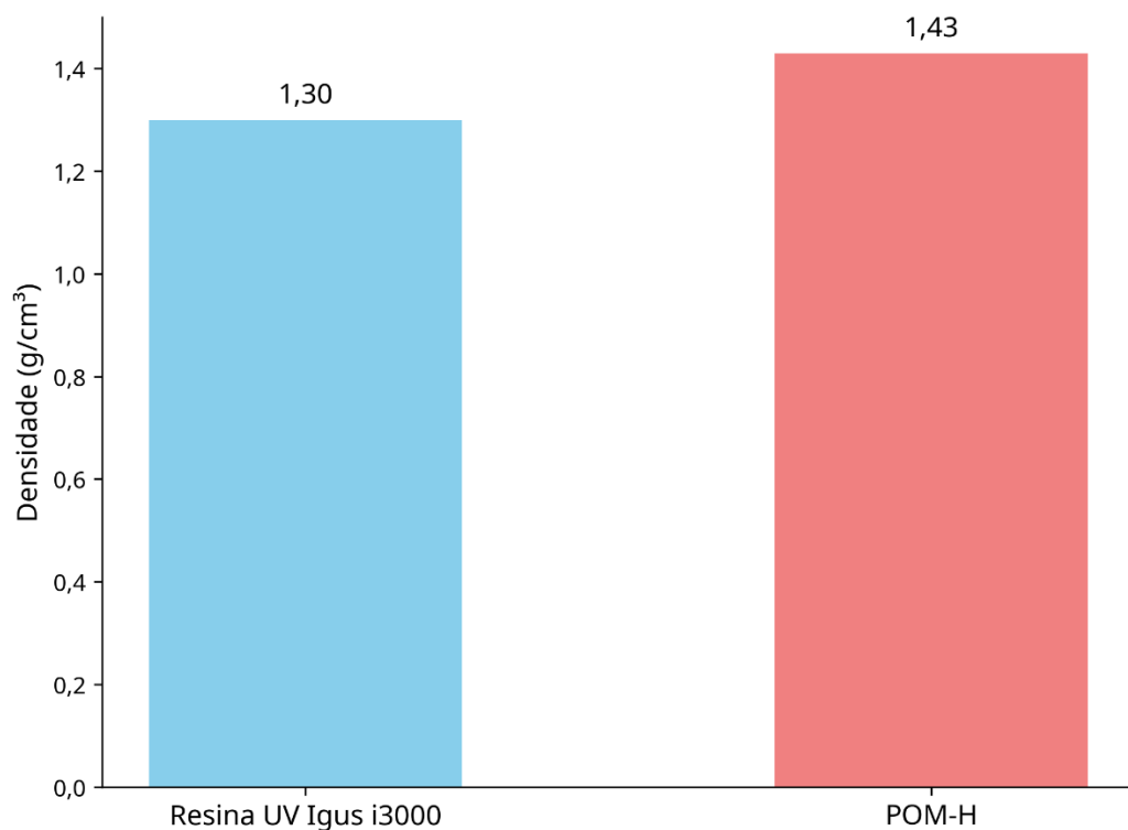
Figura 4.1 – Gráfico comparativo da densidade entre a Resina UV Igus i3000 e o POM-H
