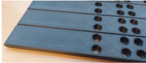
Figura 4.14 – Finger Plate com rugosidade notória antes do acabamento final (lixamento).
