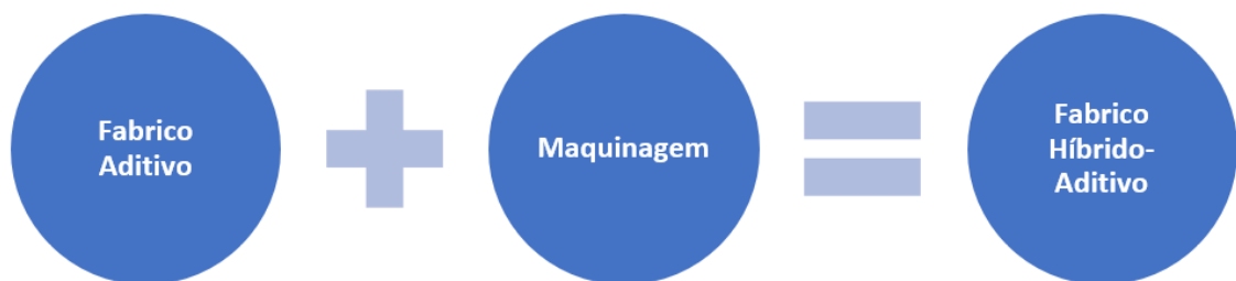
Figura 2.7 – Fabrico Híbrido-Aditivo como resultado da junção de outros dois processos.
