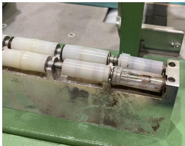
Figura 3.9 – Ruína do Rolete de POM-H devido ao desgaste.
