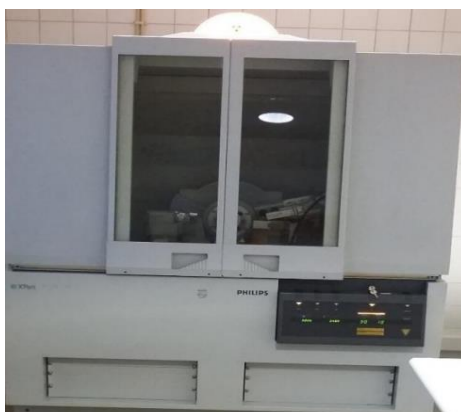
Figura 18 - Difratómetro Analytical X'Pert PRO com detector X'Celerator, varrimento angular do difratograma na gama dos 20^\circ \leq 2\theta \leq 40^\circ , com um passo de 0,017^\circ e um tempo por passo de 20 s.
