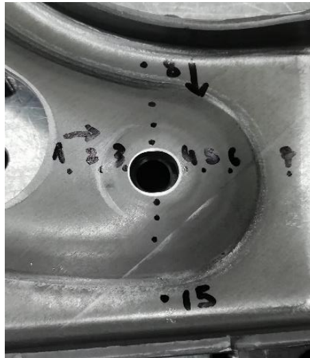
Figura 4-17 - Pontos colocados na peça para retirar as medidas de altura.
