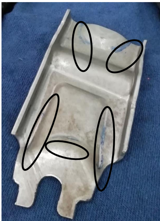
Figura 4-21 – Delimitação de zonas onde ocorre contacto entre a matriz e a peça.
