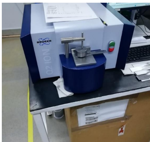
Figura 4-11 - Equipamento utilizado no ensaio químico Bruker Q2 ION.
