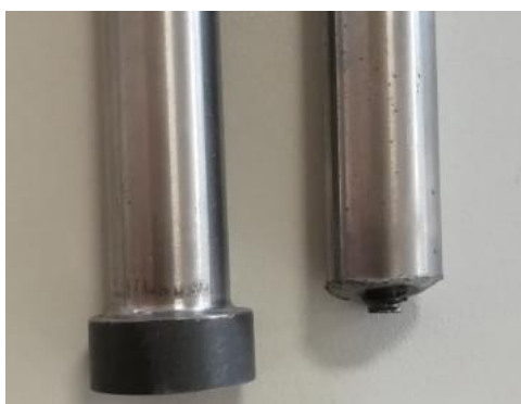
Figura 3-12 - Fratura junto da cabeça do punção.
