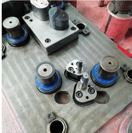
Figura 3-9 - Dispositivo de retenção de punção.
