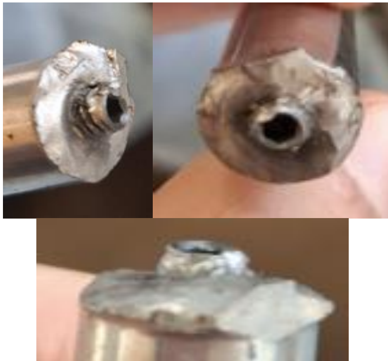
Figura 3-16 – Vista detalhada da 1ª Fratura.
