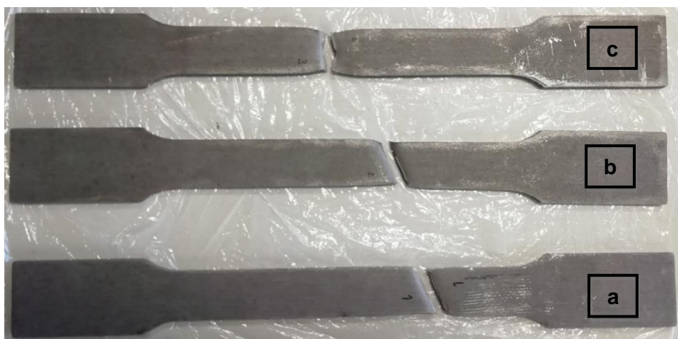
Figura 4-10 - Provetes fraturados [a] provete 1, b) provete 2, c) provete 3].
