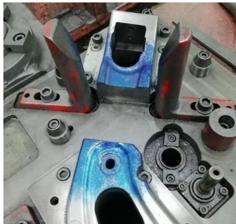
Figura 4-20 – Matriz com tinta azul para verificar o contacto.
