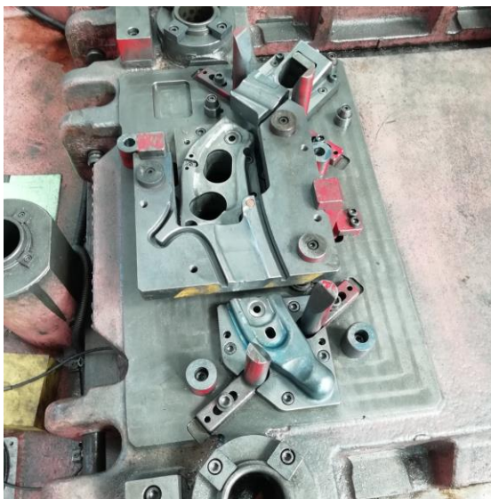
Figura 3-14 - Matriz inferior do processo de corte.
