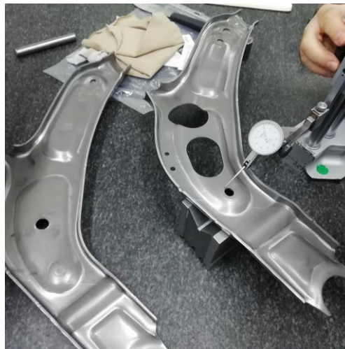
Figura 4-15 - Medição de altura da peça com utilização de um relógio comparador.
