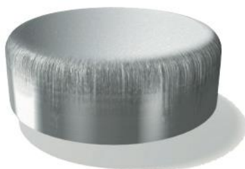
Figura 2-12 – Exemplo de desgaste num punção (Uddeholm, 2018).
