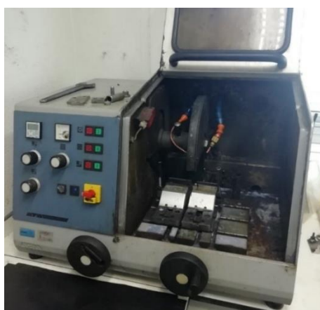
Figura 4-41 - Serra de disco utilizada para cortar os punções.
