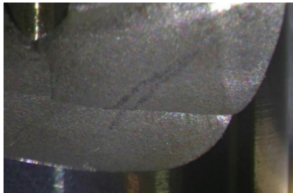
Figura 4-34 - Zona de rotura (zona 3) da Amostra A.
