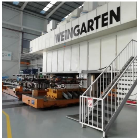
Figura 3-2 - Prensa Mecânica com capacidade de 3300kN.
