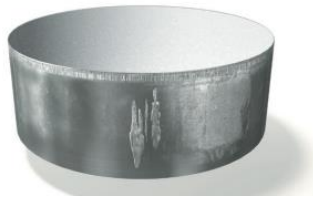
Figura 2-16 – Exemplo de escoriação num punção (Uddeholm, 2018).
