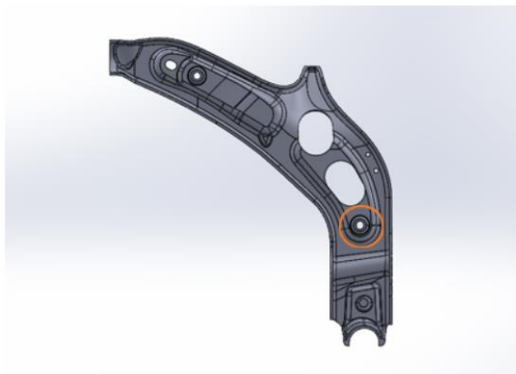
Figura 3-11 – Furo realizado pelas ferramentas de corte em questão.
