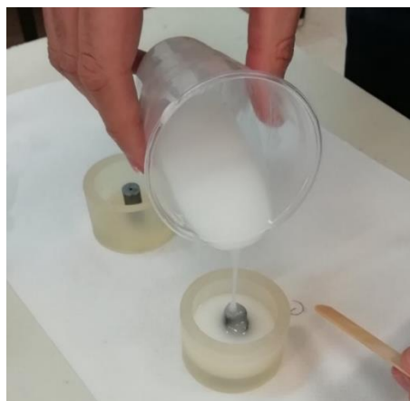
Figura 4-44 - Introdução da resina acrílica nos moldes com as pontas dos punções cortados.
