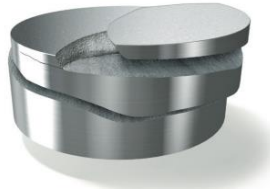
Figura 2-15 – Exemplo de fratura num punção (Uddeholm, 2018).
