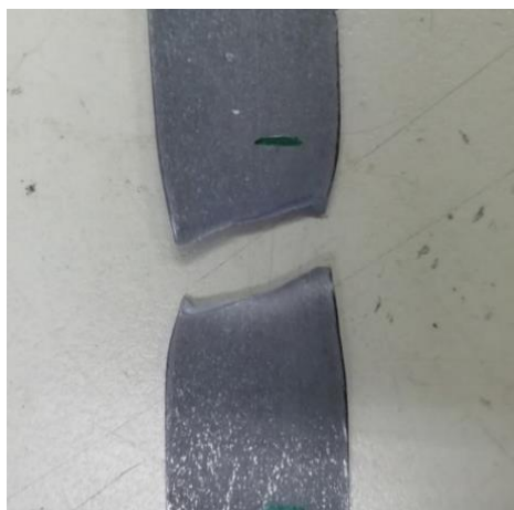
Figura 4-4 - Provete fraturado pós-ensaio à tração.
