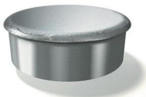
Figura 2-13 – Exemplo de deformação plástica num punção (Uddeholm, 2018).
