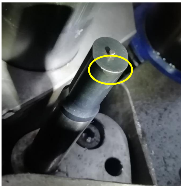
Figura 4-23 - Demonstração do desgaste no punção.
