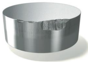
Figura 2-14 – Exemplo de lascagem num punção (Uddeholm, 2018).
