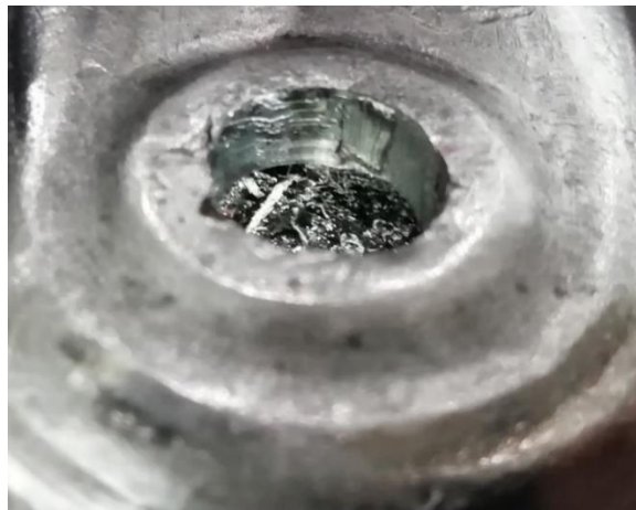
Figura 4-25 - Zona do furo do pisador, correspondente ao local onde o punção realiza maior desgaste.
