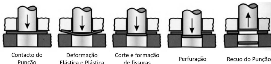
Figura 2-6- Etapas de Corte, adaptado de (Altan & Tekkaya, 2012).
