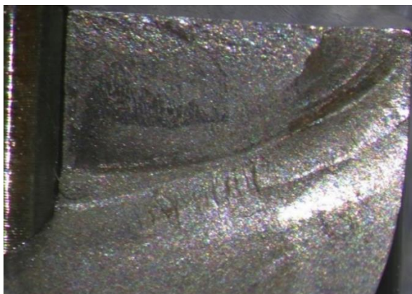
Figura 4-32 - Ampliação da Zona de Iniciação (Zona 1) da Amostra A.
