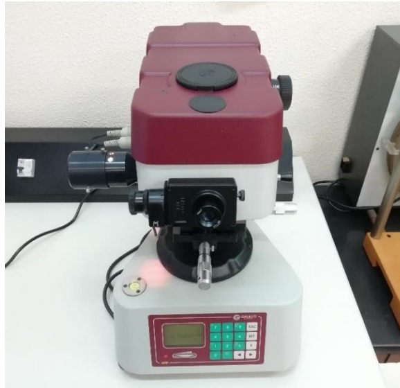
Figura 4-47 - Equipamento utilizado para realizar as indentações nas amostras.
