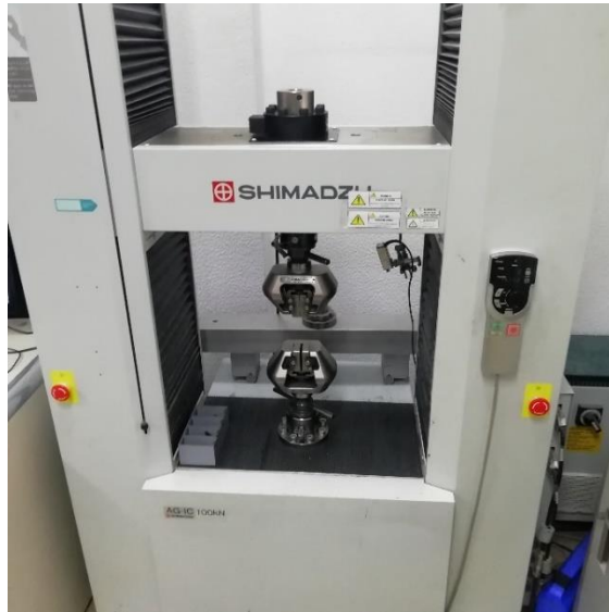
Figura 4-1 - Equipamento Shimadzu AG-IC 100kN para realização dos ensaios de tração.
