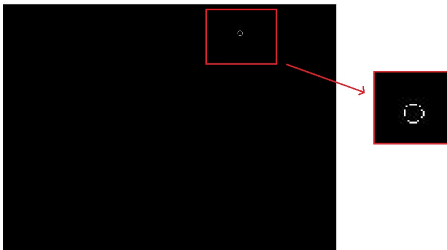
Figura 3.9: Obtenção dos contornos da fibra através do Algoritmo de Canny
