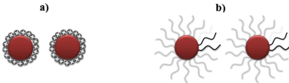
Figura 8 – Ilustração esquemática da estabilização de partículas pelo efeito eletrostático (a) e estérico (b).
