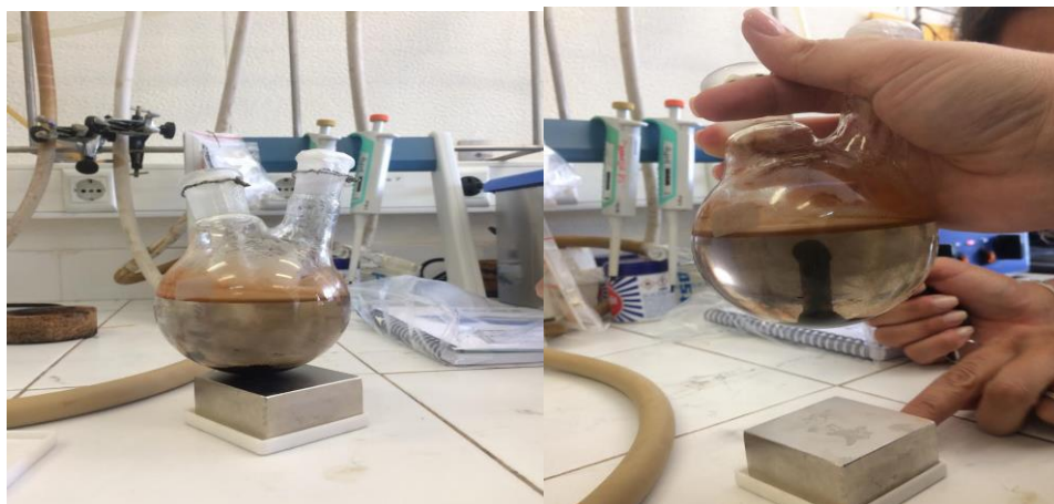
Figura 13 - Comportamento das nanopartículas magnéticas de \text{Fe}_3\text{O}_4 sintetizadas na presença de um campo magnético exterior
