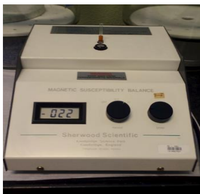
Figura 11 - Balança para medição de suscetibilidade magnética.
