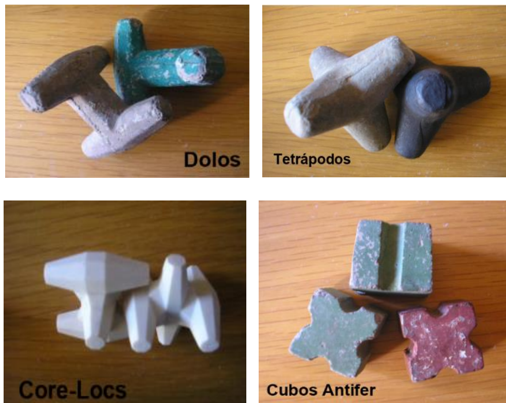
Figura 2.6 - Exemplos de blocos artificiais de betão
