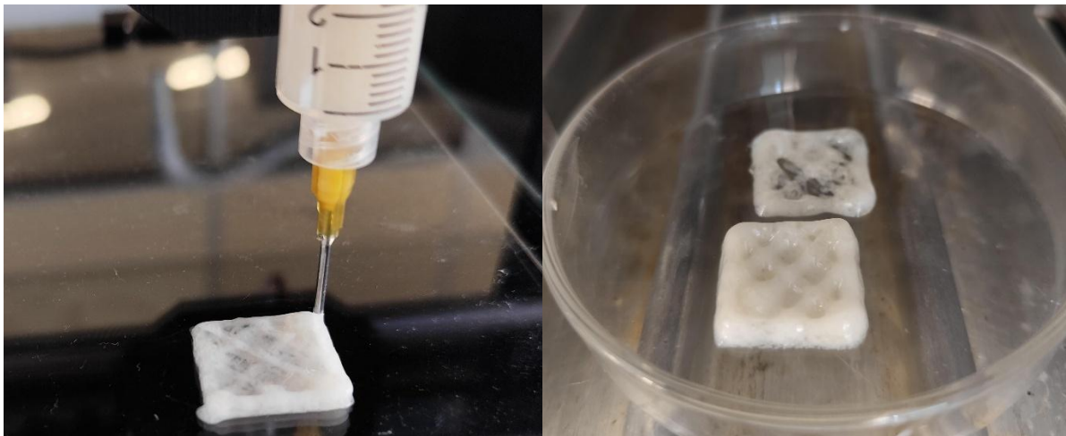
Figura 4.15 - Registo do trabalho e resultado com a pasta de alginato de sódio, kaolin e quitosano
