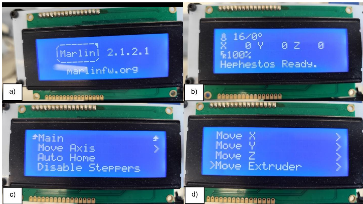
Figura 4.3 - a) Monitor com indicação do software utilizado; b) menu principal com indicação da T ambiente; c) menu de comandos; d) menu de movimentação de eixos e extrusor
