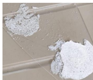
Figura 4.18 - Tentativa de impressão de uma estrutura à base de pasta de PVA
