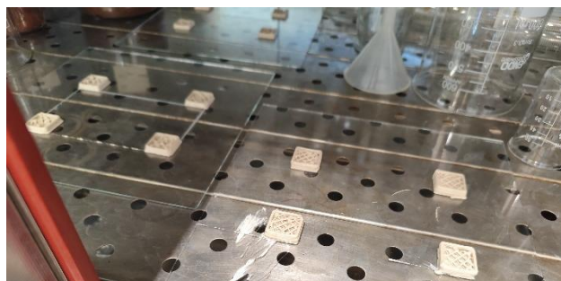
Figura 4.11 - Demonstração do processo de desidratação das estruturas impressas
