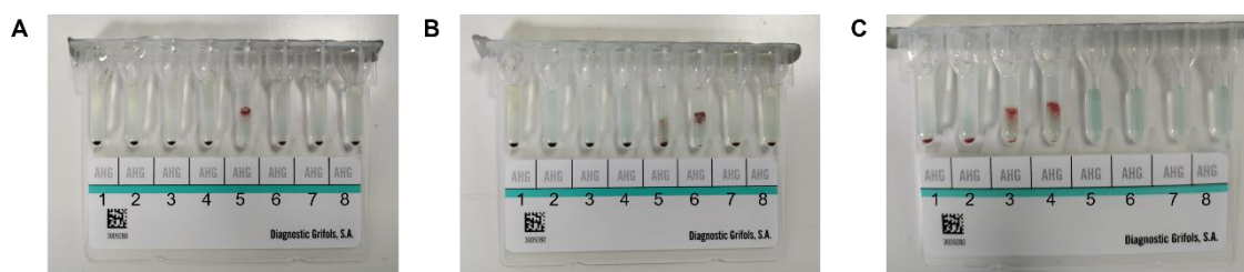
Figura 4.18: Reação de Coombs direta e PAI no sistema WADiana® Compact . Na reação de Coombs direta, os eritrócitos sensibilizados por anticorpos humanos IgG ou frações do complemento na amostra reagem com os anticorpos na coluna de gel, ocorrendo aglutinação. Na PAI, a aglutinação ocorre se a amostra apresentar anticorpos contra os antígenos eritrocitários dos reagentes. Num resultado positivo, os eritrócitos aglutinados são capturados na coluna de gel, enquanto num resultado negativo os eritrócitos formam um sedimento. A: Resultado negativo (poços 1-4 e 6-8) e positivo (poço 5). B: Resultado negativo (poços 1-4, 7 e 8) e positivo (poços 5 e 6). C: Resultado negativo (poços 1 e 2), positivo (poços 3 e 4) e os poços 5-8 estão por utilizar. Figura do autor.
