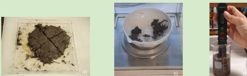
Figura – Amostragem e Parâmetros: a) Amostragem do conteúdo do compostor b) Determinação de ST e STV e STF através de método gravimétrico; c) Determinação de pH através de método eletroquímico
