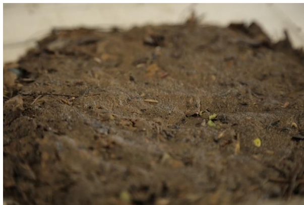
Figura 5.2-Composto retirado dos compostores para determinação de parâmetros físico-químicos
