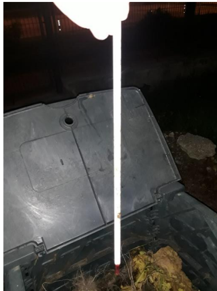
Figura 6.8-Medição da temperatura no compostor
