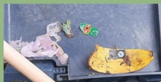
Figura 5 – Exemplo de plásticos em biorresíduos detetados no compostor
