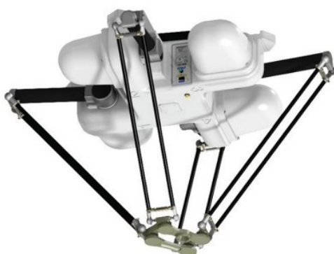
Figura 2.10 – Exemplo de robô paralelo, adaptada de P. Li (2020).
