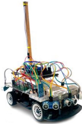
Figura 2.21 – Protótipo de veículo autónomo modificado, adaptada de Marçal (2023).
