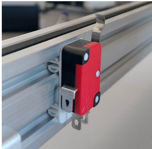
Figura 3.48 – Impressão 3D do adaptador sensor de fim de curso e eixo linear.
