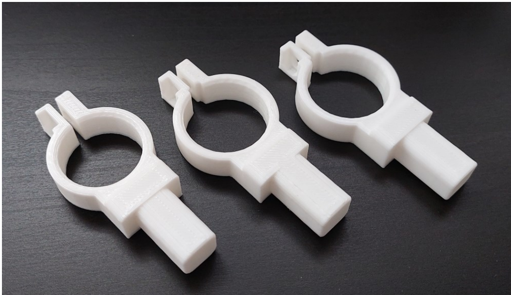
Figura 3.46 – Impressão 3D das iterações do adaptador Dobot Magician e I-Extruder.
