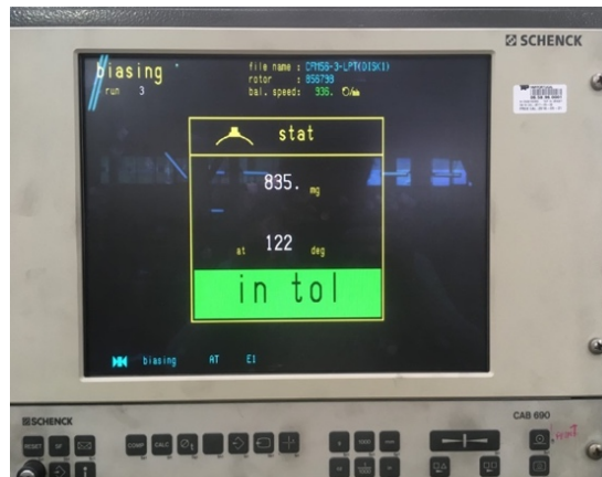
Figura 55 - Display da massa de correção e o ângulo a corrigir numa equilibragem estática, fonte: TAP
