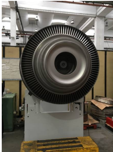
Figura 21 - Módulo de LPT em processo de equilibragem, fonte: TAP
