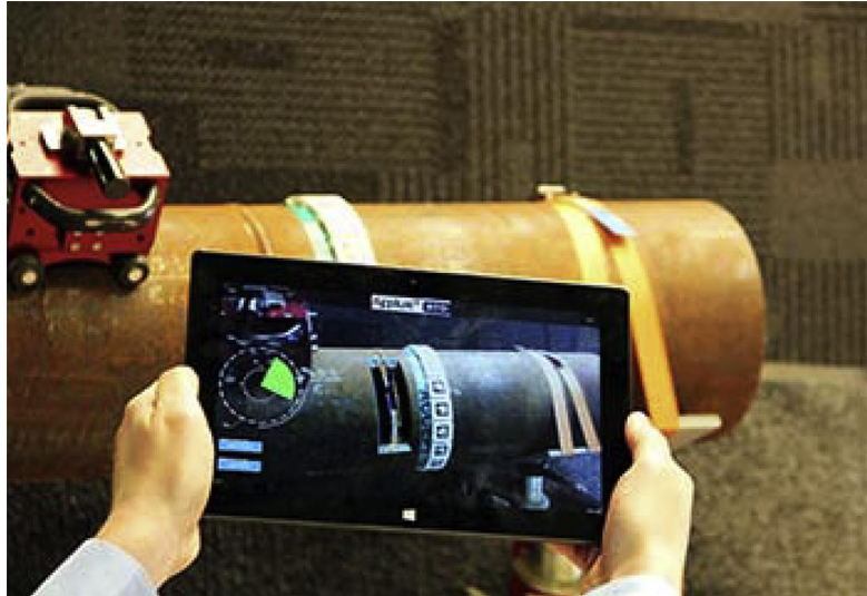
Figura 3.6 - Realidade Aumentada aplicada a ensaios não destrutivos em condutas [58]
