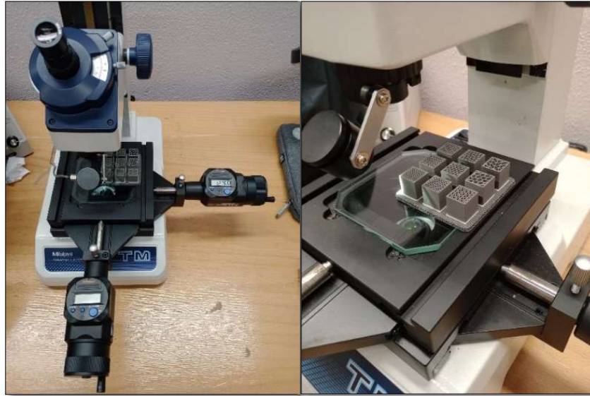
Figura 3.10 - Microscópio Mitutoyo TM utilizado para as medições das estruturas impressas.
