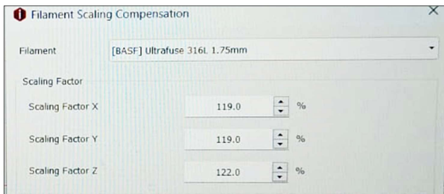
Figura 3.5 - Parâmetros de redimensionamento para compensar a contração das estruturas impressas nas fases de pós-processamento.
