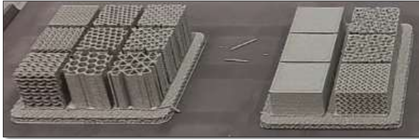
Figura 3.8 - Estruturas de aço inoxidável 316L com e sem parede logo após sinterização.
