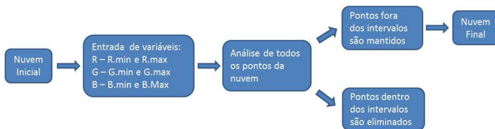
Figura 5.10: Esquema do procedimento selecRGB - Anexo A.5
