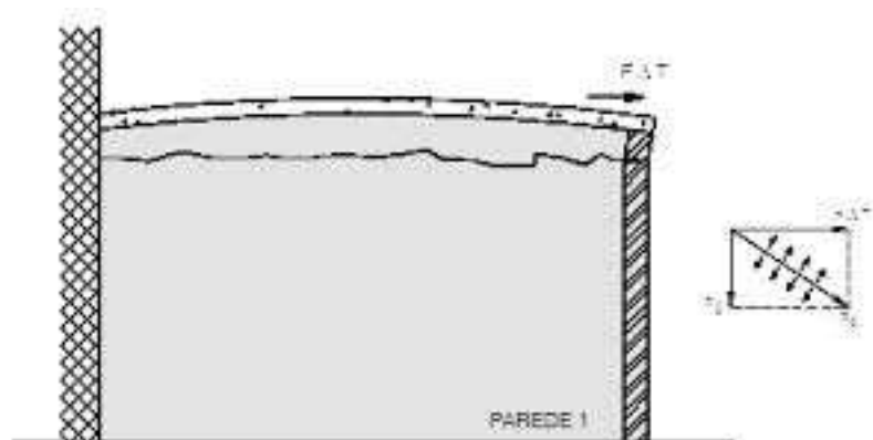
Figura 2.2: Fissuração por diferenciais térmicos
