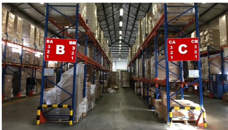
Figura 3.11 – Proposta para identificação das racks no Armazém Central de Sacavém
