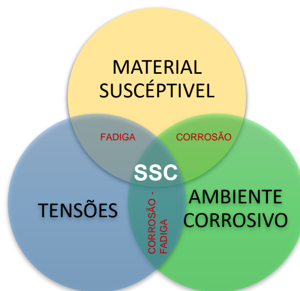
Figura 2.18 – Os três fatores subjacentes à corrosão sob tensão [37].
