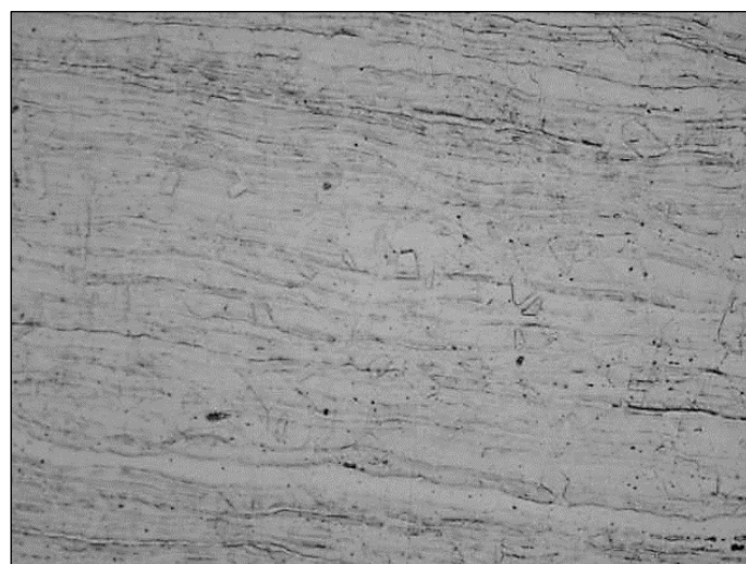
Figura 4.24 – Fotomicrografia ilustrativa da microestrutura constituinte do material base da amostra B (Ampliação no original 500X)
