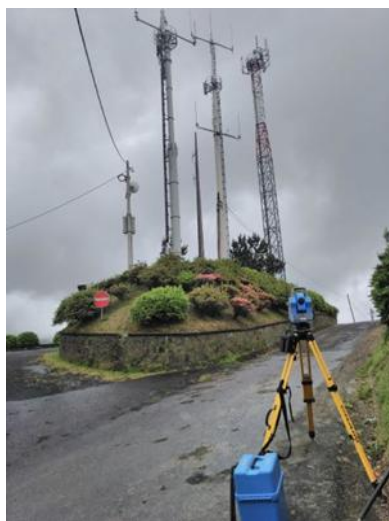
Figura 3.1 – Ensaio de verticalidade com recurso a estação total
