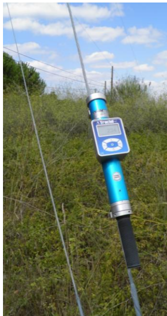
a) Vista geral da aplicação do tensiómetro no cabo
