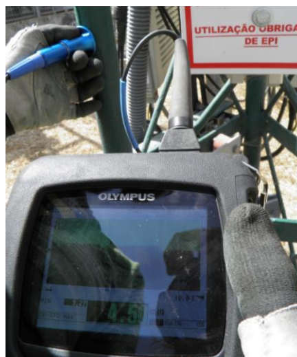
Figura 3.2 – Ensaio de medição espessura de aço
