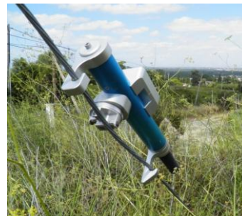
b) Posição do tensiómetro no cabo
