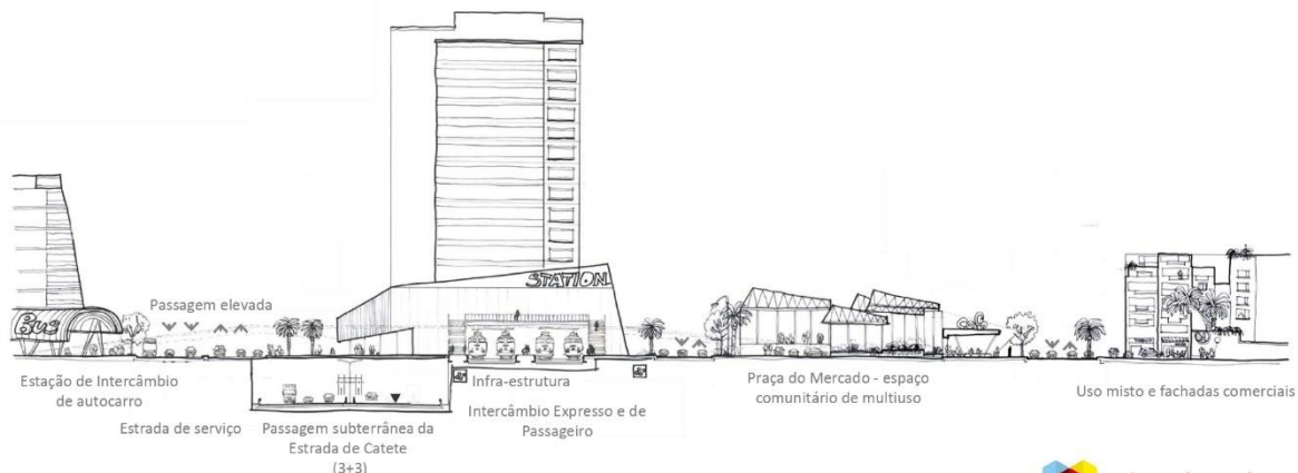
Perfil – Estação de Transferência em Viana
