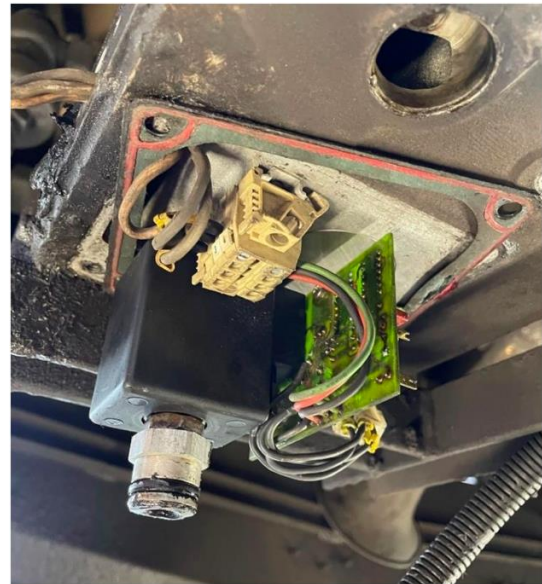
Figura 6.16 - Placa de circuitos impressos para comutação entre vasos da torre de secagem.
