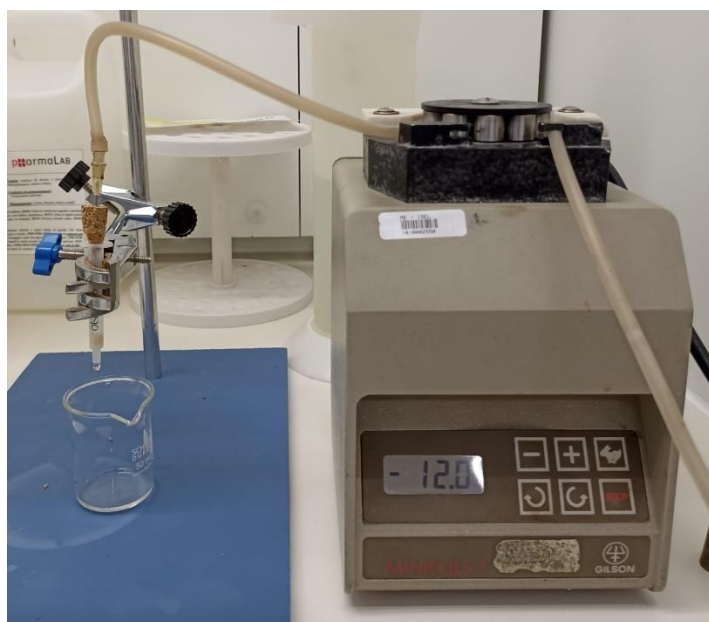
Figura 3.4: Extração em fase sólida (SPE) com auxílio de uma bomba peristáltica.
