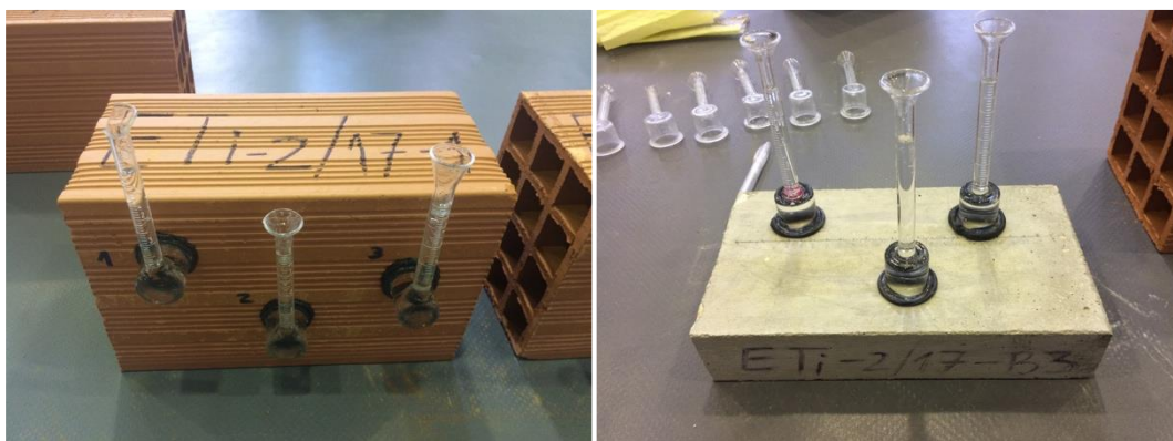
Figura 4.17 a) e b) - Tubos de Karsten aplicados em superfícies verticais e superfícies horizontais.
