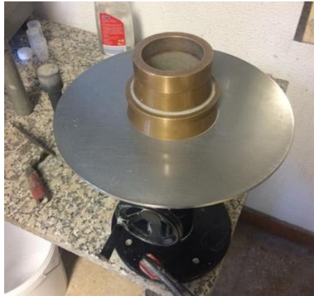
Figura 4.5 - Disco da mesa de espalhamento e molde antes do ensaio.
