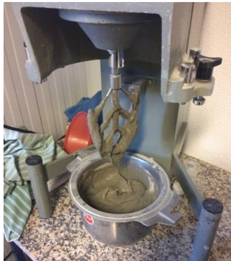
Figura 4.4 - Pasta homogénea sem grumos.
