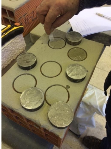
Figura 4.31 - Colagem das pastilhas metálicas.
