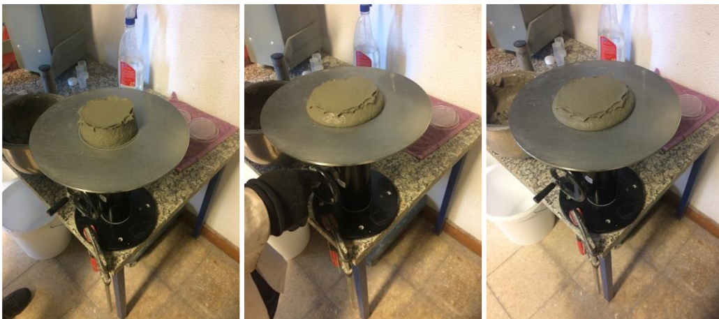
Figura 4.10 a), b) e c) - Espalhamento da argamassa em pasta.
