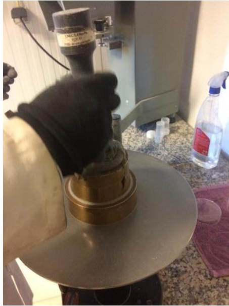
Figura 4.7 - Segunda camada de argamassa de colagem compactada com 10 pancadas.
