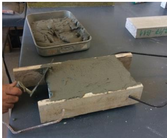
Figura 4.1 - Aplicação da argamassa de colagem com 10 mm de espessura no suporte.
