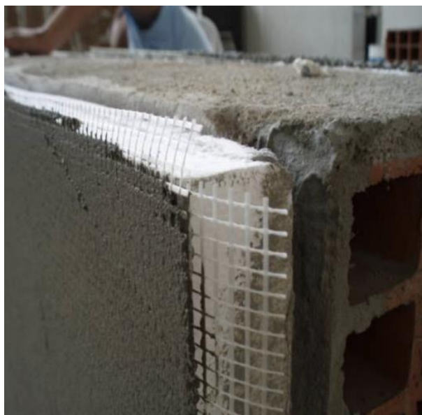
Figura 2.4 - Sistema ETICS com isolante térmico fixado por colagem aplicado sobre murete para ensaio laboratorial [14].
