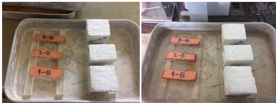
Figura 4.28 a) e b) - Amostras apoiadas em elementos e face das amostras em contacto com a água.
