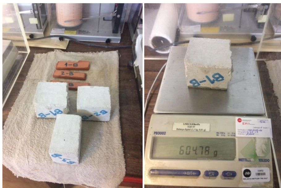
Figura 4.29 a) e b) - Amostras com face em contacto com um pano húmido e pesagem das amostras após face em contacto com a água.
