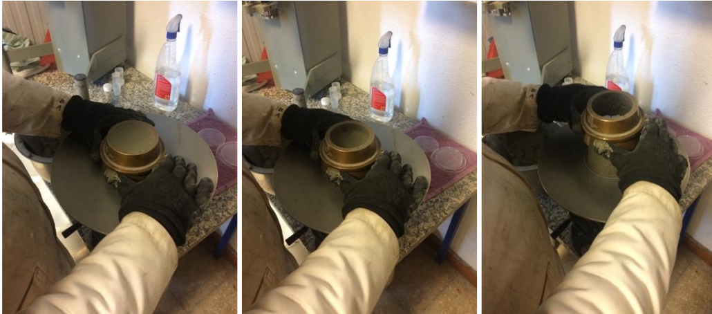
Figura 4.9 a), b) e c) – Remoção do molde.
