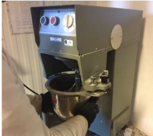
Figura 4.3 - Misturador a trabalhar a velocidade lenta enquanto se adiciona água.
