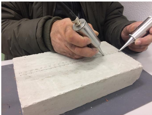
Figura 4.16 – Medição da velocidade de ondas ultrassónicas por transmissão indireta.
