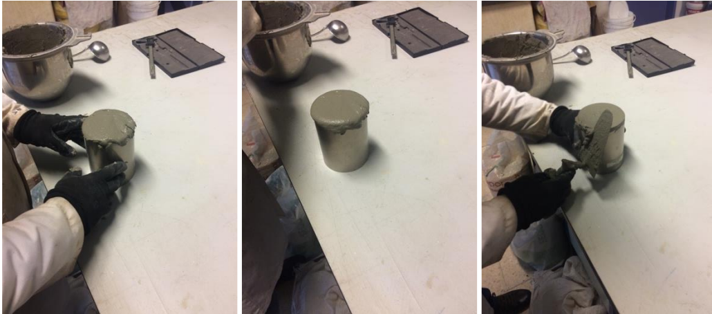
Figura 4.14 a), b) e c) - Enchimento da cápsula até transbordar e remoção do excesso.
