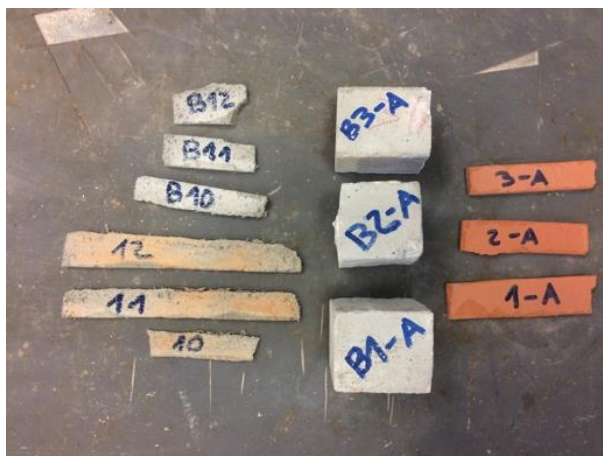
Figura 4.21 - Amostras extraídas de provetes para determinação da porosidade aberta.
