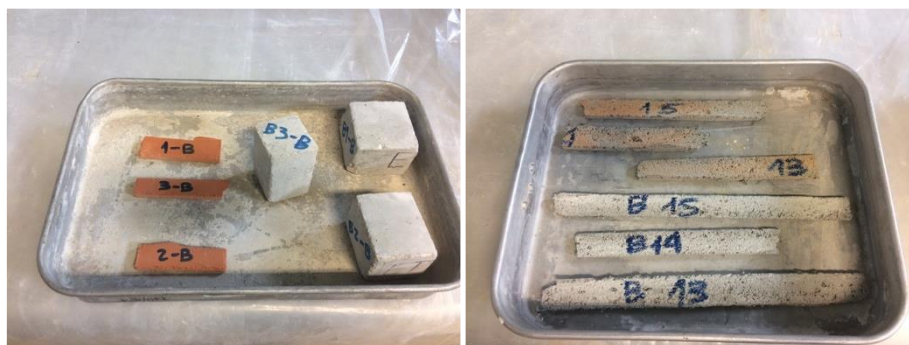
Figura 4.25 a) e b) - Amostras extraídas de provetes para determinação do teor de humidade.
