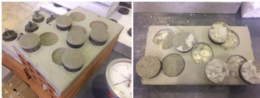
Figura 4.34 a) e b) - Pastilhas metálicas após arrancamento em tijolo cerâmico e em betão.
