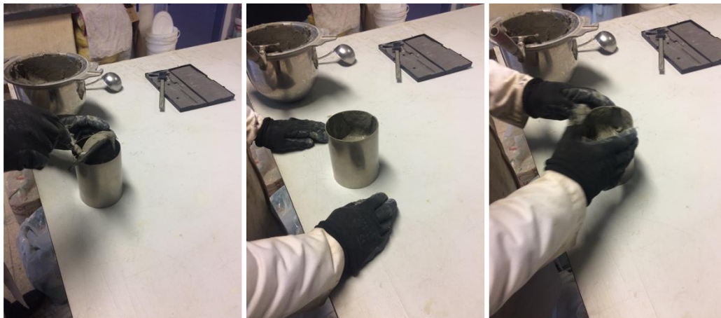
Figura 4.13 a), b) e c) - Enchimento e compactação da cápsula.
