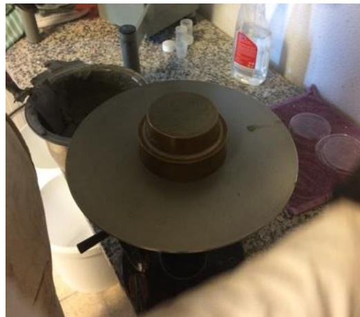
Figura 4.8 - Molde com superfície lisa após se retirar o excesso de pasta.
