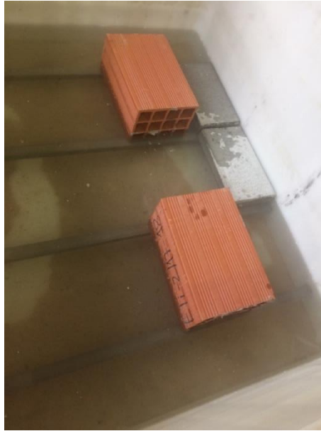
Figura 4.35 - Imersão da camada adesiva dos provetes durante 48 horas.
