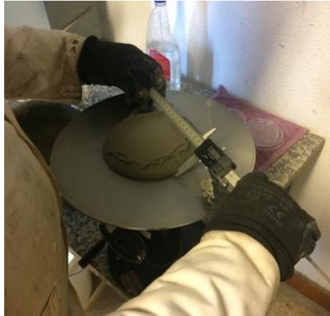
Figura 4.11 - Medição do espalhamento com craveira.
