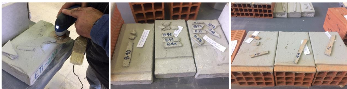
Figura 4.20 a), b) e c) - Extração de amostras dos provetes de argamassa de colagem aplicada em betão e em tijolo cerâmico.
