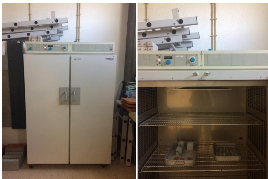
Figura 4.26 a) e b) - Estufa ventilada e colocação dos tabuleiros na estufa.
