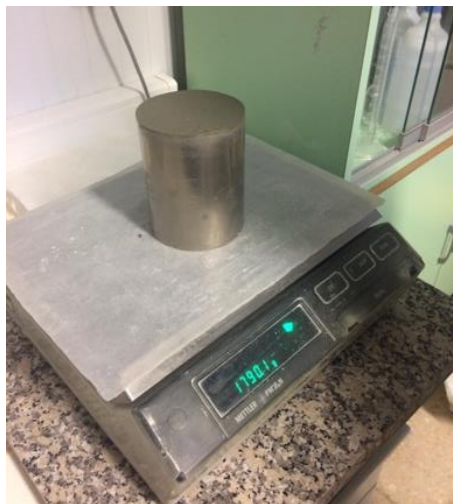
Figura 4.15 - Pesagem da cápsula cheia com a pasta.
