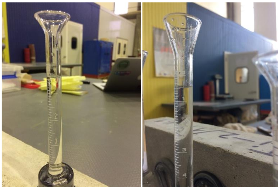
Figura 4.18 a) e b) - Tubos de Karsten com água.
