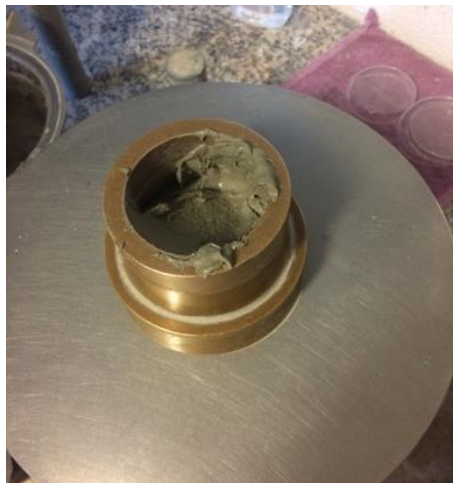
Figura 4.6 - Primeira camada de argamassa de colagem compactada com 10 pancadas.
