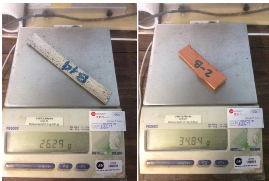
Figura 4.27 a) e b) - Pesagem das amostras a cada 24 horas.
