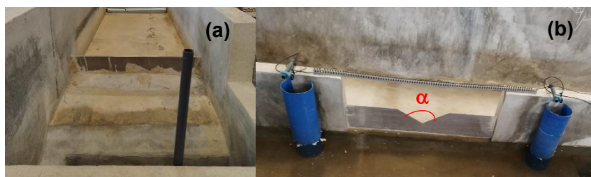
Figura 3.5 – Descarregadores existentes na instalação. (a) descarregador retangular; (b) descarregador em “V-Notch”
