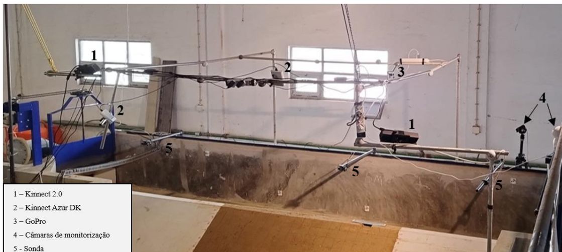
Figura 3.6 – Instrumentação utilizada e a sua localização na instalação
