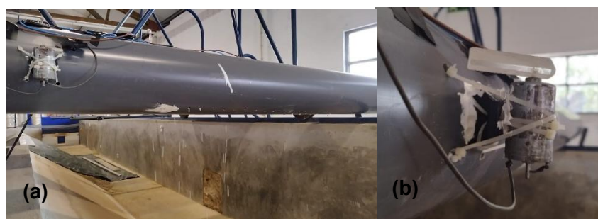
Figura A.8 – Dispensador de partículas. (a) Dispensador (Tubo PVC); (b) motor
