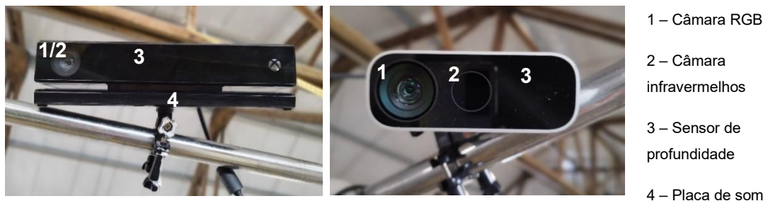
Figura 3.10 – Componentes dos sensores Kinect 2.0 e Kinect Azure DK
