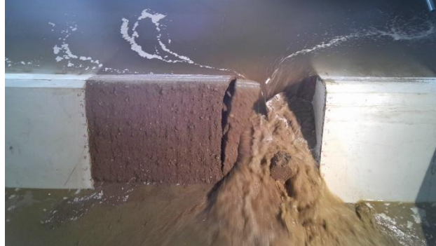
Figura 3.11 – Queda de bloco (Primeiro ensaio)
