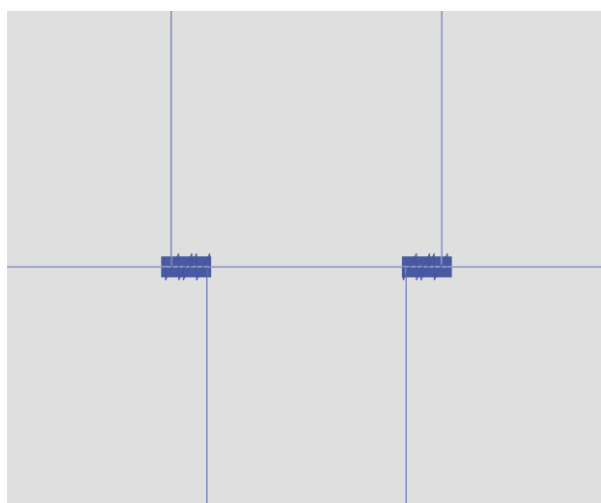
Figura 3-10 - Ligação de elementos desalinhados
