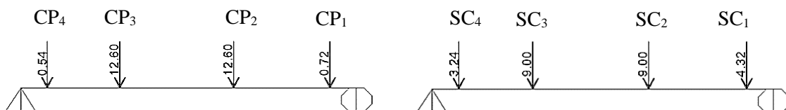
Figura 3.21 – Cargas Permanentes e Sobrecargas nas Carlingas
