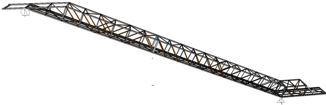
Figura 4.1 – Esquema em 3D da Ponte Metálica
