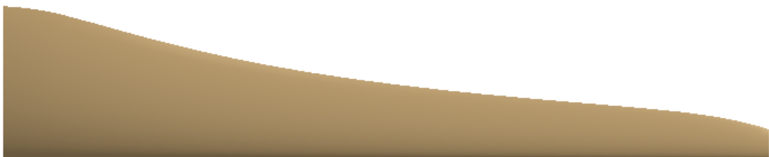
Figura 6.27: Plano forma da pá com o design ideal.
