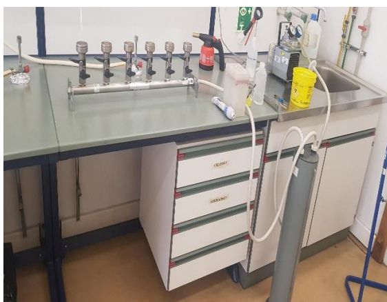
Figura 20 - Rampa de filtração
