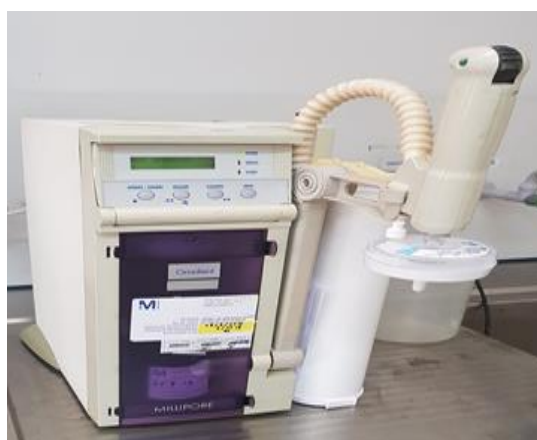
Figura 19 - Equipamento de água MilliQ
