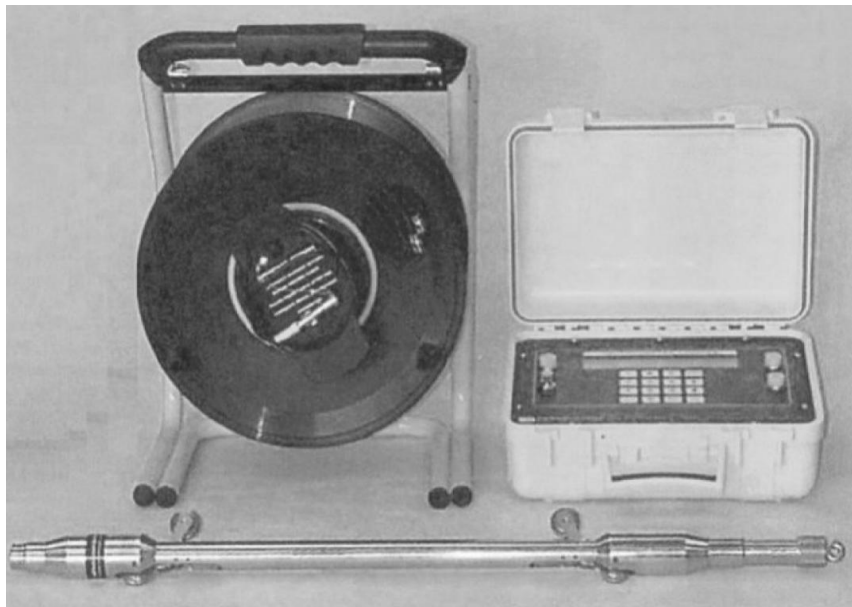
Ilustração 37 - Sonda inclinométrica - inclinómetro (adaptado de Melâneo [10]).
