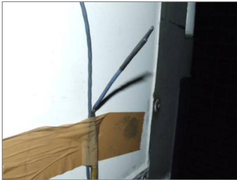
Figura 1 - Pormenor de um sensor de temperatura colocado no exterior do veículo
