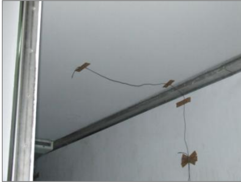
Figura 2- Montagem dos sensores no interior do veículo
