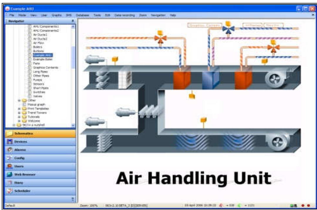
Figura 2.4 – Software de monitorização de uma UTA em ambiente Windows (Morphfx, 2011)
