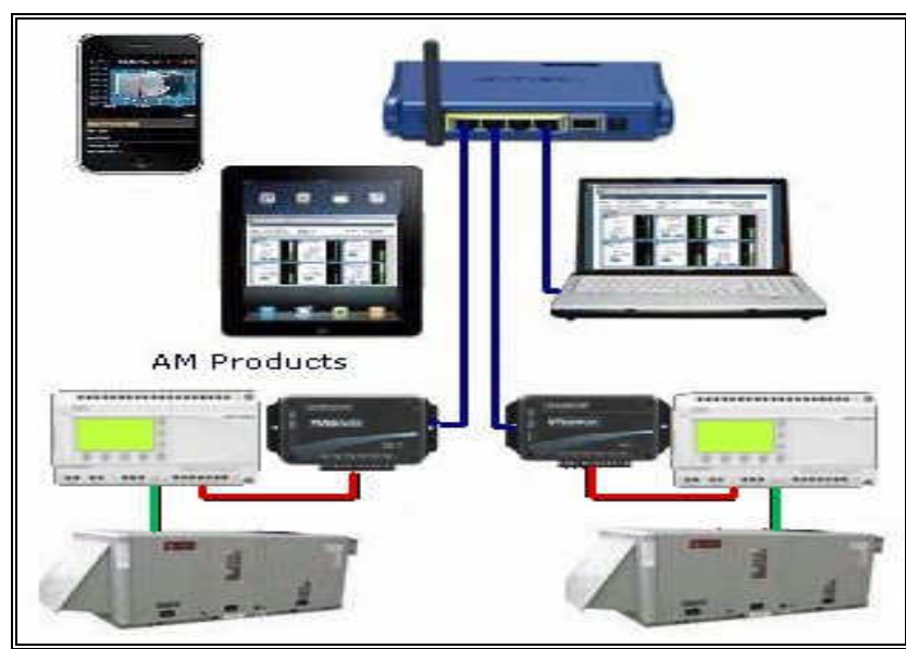
Figura 2.2 – Manutenção preventiva com recurso a monitorização (Mitplc, 2011)
