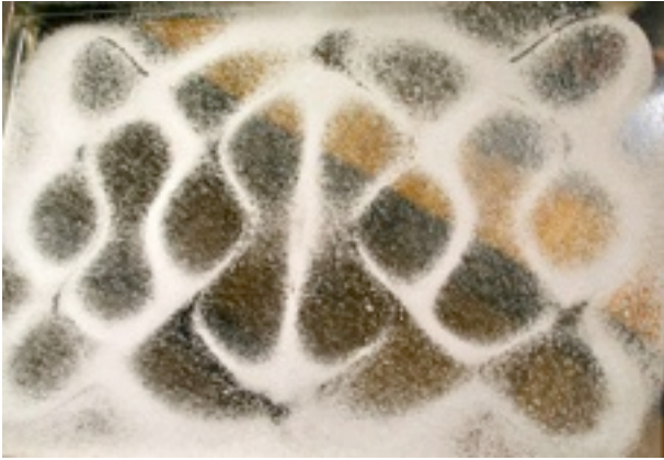
Figura de Chladni produzida em chapa metálica em vibração com grãos de sal. Quando a chapa é posta em vibração, o sal acumula-se nas linhas nodais - zonas de vibração nula. Assim, o som provoca uma perturbação num corpo e define forma/ espaço.
