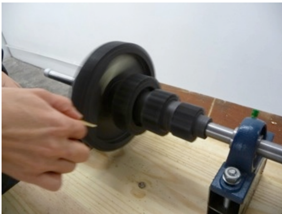
Motor com rodas dentadas agregadas ao seu eixo. Da esquerda para a direita: roda com 60 dentes, 30, 20 e 15 dentes. Quando em movimento, se fizermos percutir uma palheta nas rodas temos intervalos de: oitava perfeita, quinta perfeita, quarta perfeita. Entre rodas extremas temos duas oitavas. O timbre depende do material da palheta. Com o aumento da velocidade, aumenta a frequência sonora (mais rápido = mais agudo, mais lento = mais grave, muito lento = ritmo). Os intervalos entre rodas mantêm-se independentemente da velocidade.
