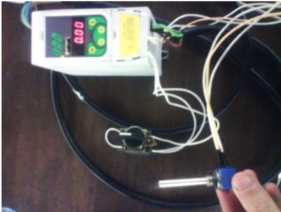
Controlador de velocidade com interruptor para mudança de direcção da rotação, e potenciômetro para controlo da velocidade.
