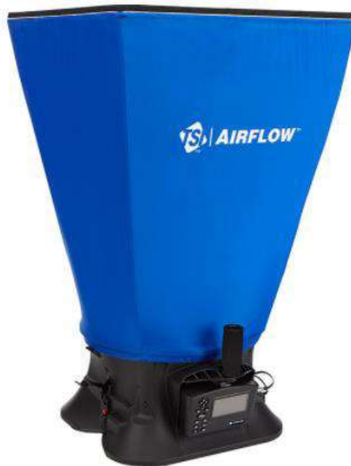
Figura 4.8 – Exemplo de um balômetro
