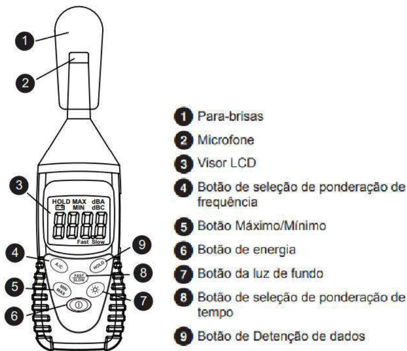
Figura 5.4 – Legenda de utilização de um sonómetro
