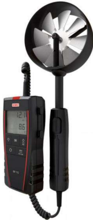
Figura 4.7 – Exemplo de um termo-anemómetro do tipo hélice
