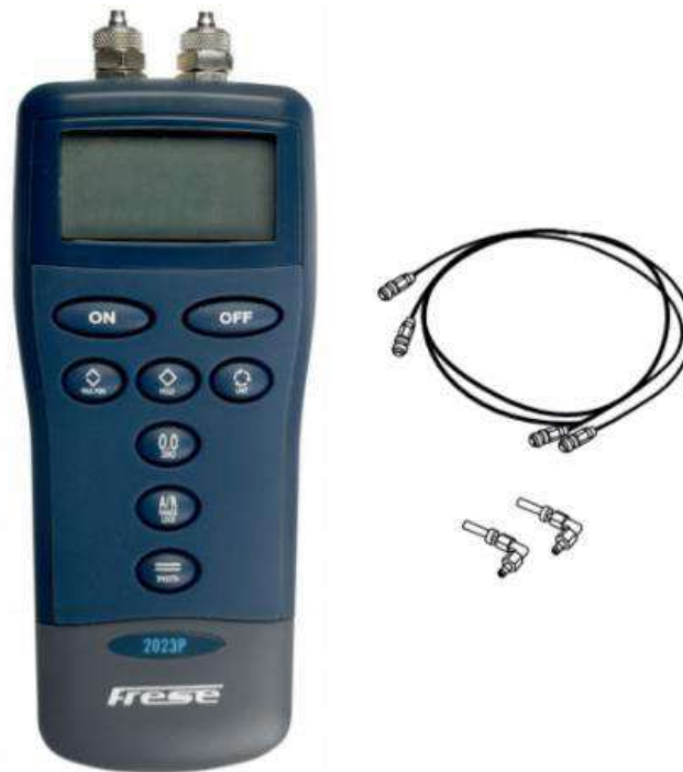
Figura 4.2 – Exemplo de medidor de pressão diferencial
