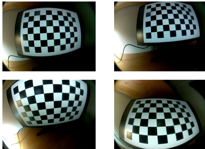
Figura 3.6: Exemplo de imagens utilizadas na calibração da câmara
