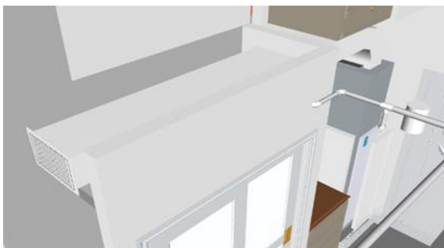
Figura 51- Verificação da colocação do sistema de ar condicionado
