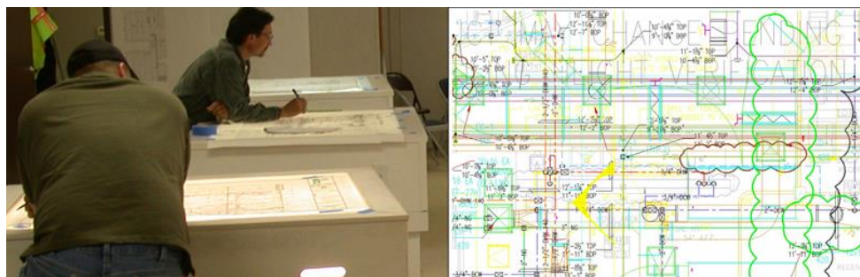
Figura 5- Análise de conflitos entre especialidades em mesas de luz (adaptado de (Berdeja, 2014))
