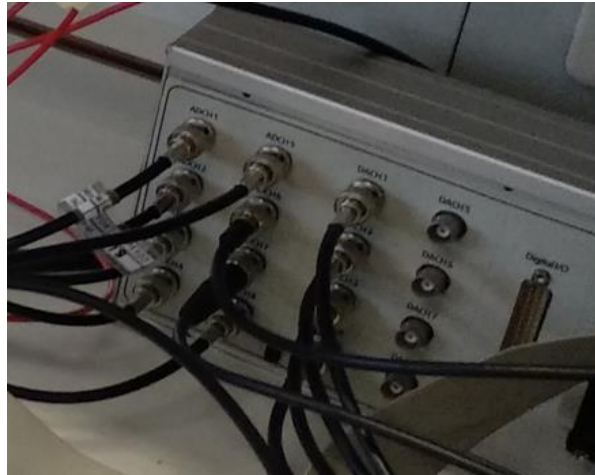
Figura 88 – Interface de hardware do DSP (fabricante dSPACE, modelo 1104)
