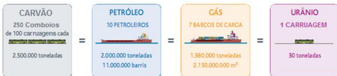
Figura 5.1 - Equivalência de abastecimento de combustível para uma central eléctrica de 1000 MWe [21]
