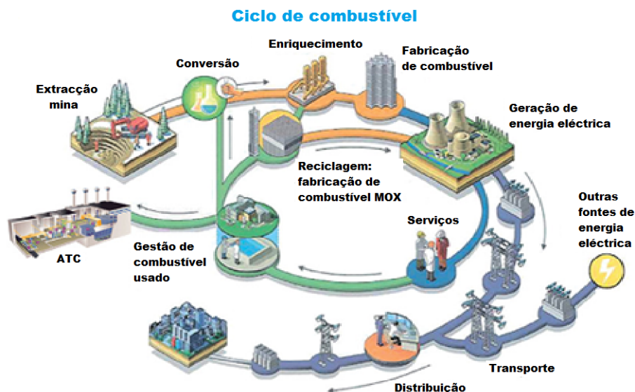
Figura 3.8 - Esquema de ciclo de combustível aberto e fechado [21]
