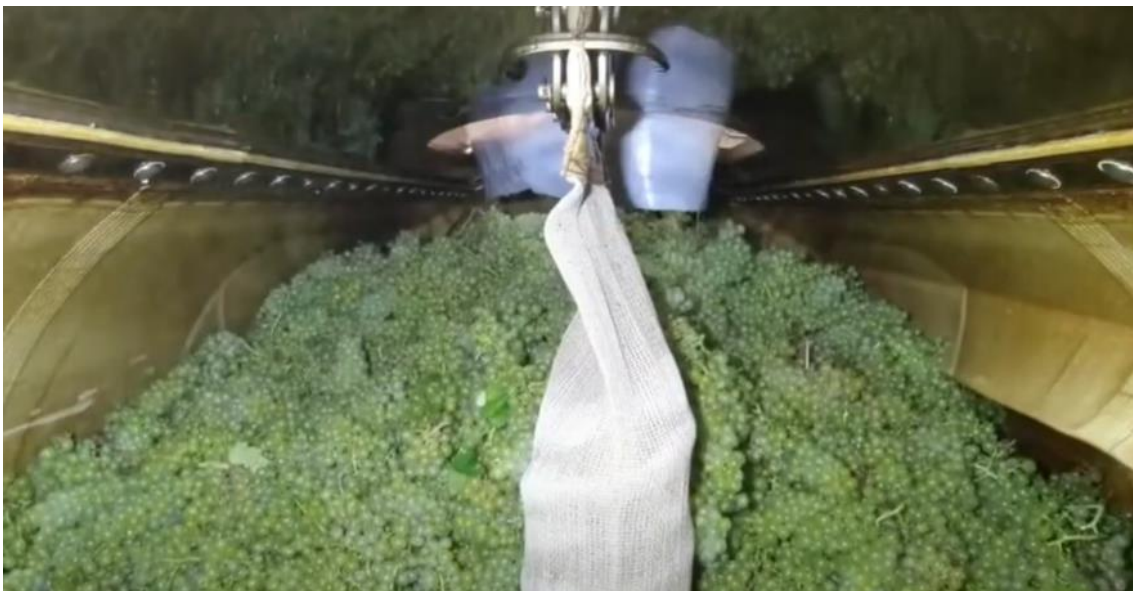
Figura 3-15 Vista interior de uma prensa pneumática no carregamento de uvas brancas (Fonte: Autor)
