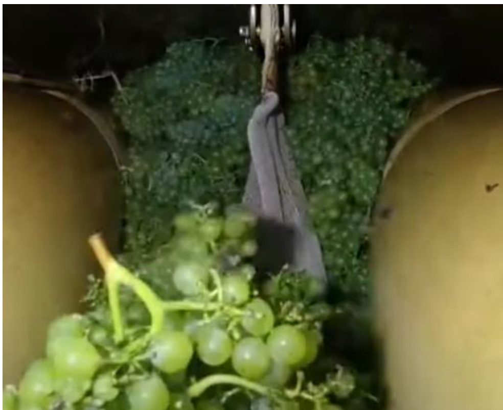
Figura 3-16 Vista interior de uma prensa pneumática no momento da prensagem das uvas brancas (Fonte: Autor)
