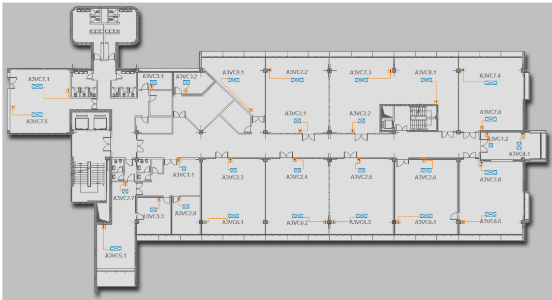
Figura 87 – Disposição das unidades interiores e controladores locais, nas salas do piso 3 do edifício A.
