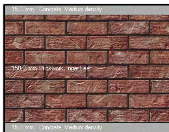
Figura 39 – Esquema da parede interior I. Fonte: DesignBuilder/Construction.
