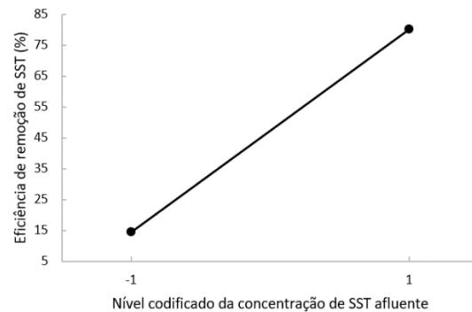
Figura IV. 19. Representação gráfica do efeito da concentração de SST afluente (B) na eficiência de remoção de SST – ETAR Y
