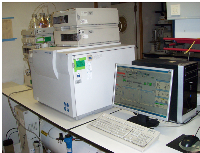
Figura 11. Cromatógrafo líquido acoplado a espectrômetro de massa (Agilent, 1100 series)
