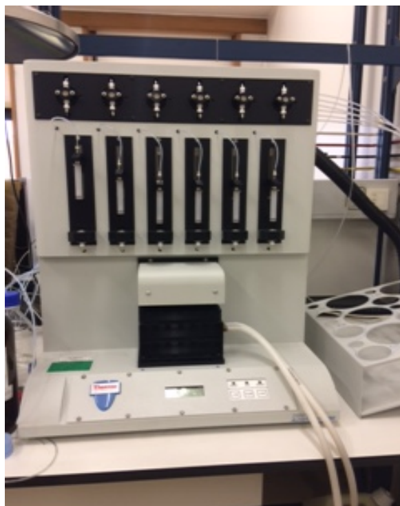
Figura 20. Sistema automático de extração de amostras em fase sólida (ThermoScientific AutoTrace 280 – Dionex)
