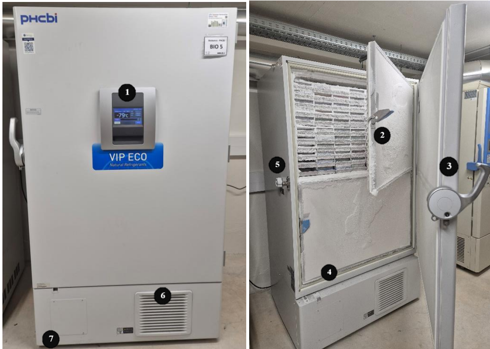
Figura 8 - Localização dos componentes do ultracongelador -80°C.
