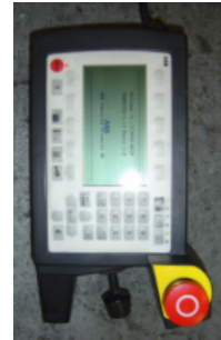
Figura 8 - Sistema de controlo ABB S4 [4].
