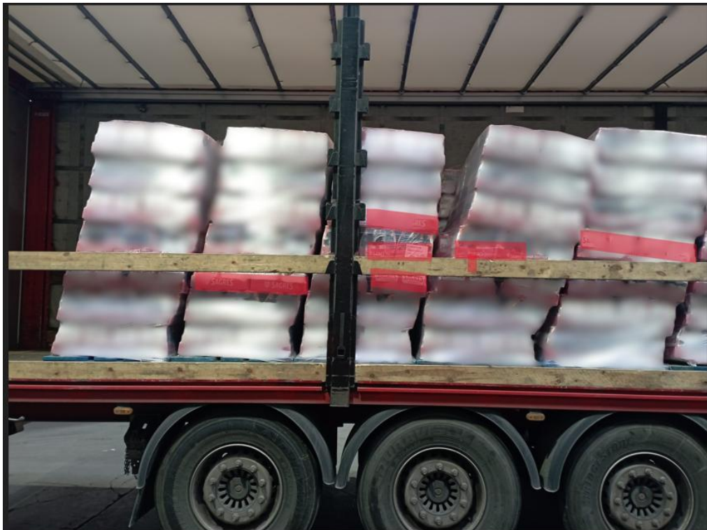
Figura 3.1 – instabilidade de unidades de carga durante o transporte.
