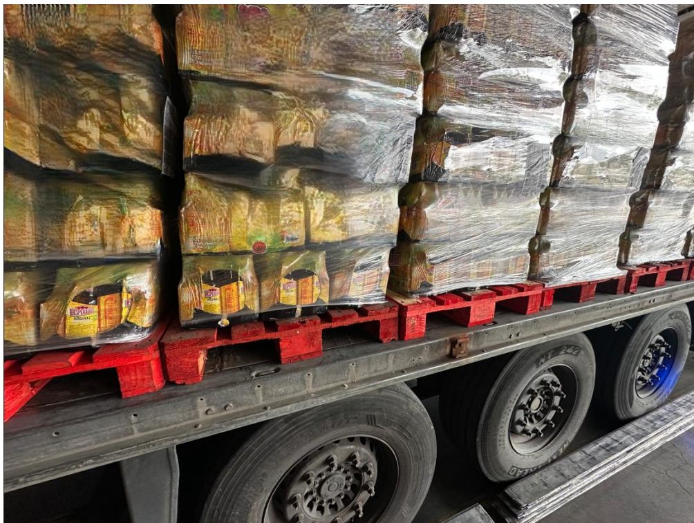
Figura 3.3 – Envolvimento insuficiente da base da paleta.
