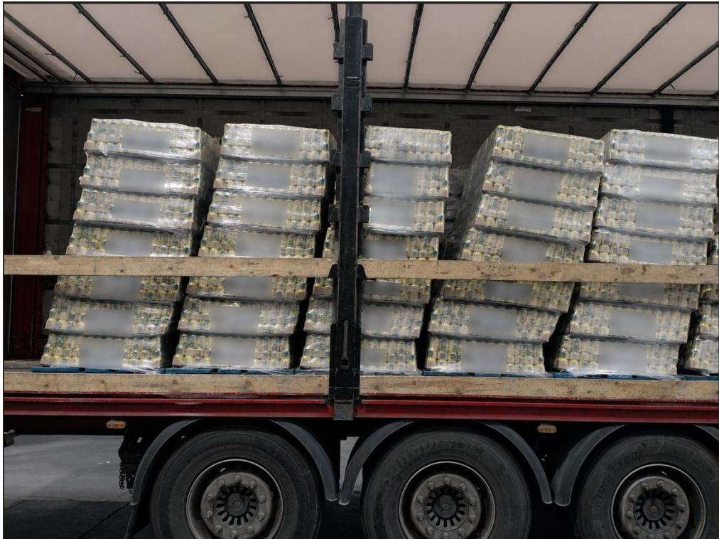
Figura 3.2 – Inclinação das unidades de carga paletizadas.
