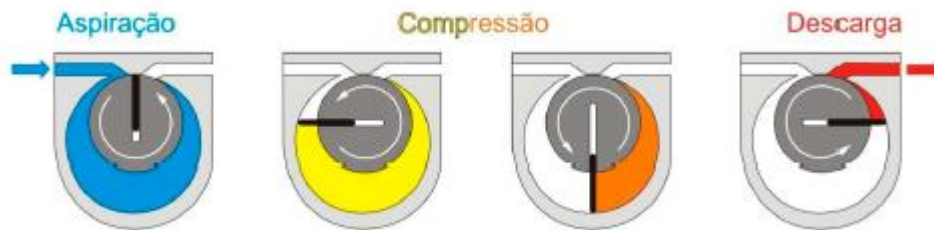
Figura 2.3 - Funcionamento de um compressor de palhetas.
