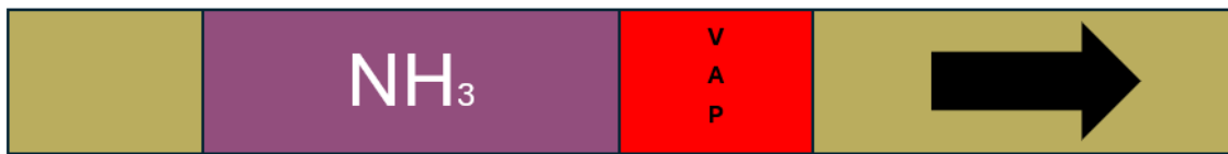
Figura 4.23 - Exemplo de etiqueta para tubagem de amoníaco.
