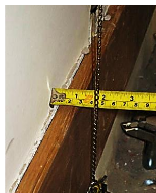
Figura II.7.6 – Edifício Sede de Escritórios em Coimbra - Sondagem S2.3 (Inclinação da parede de fachada)
