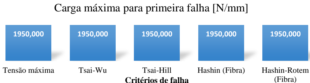
Figura 47 - Carga máxima obtida para primeira falha nos diversos critérios de falha do estudo E1
