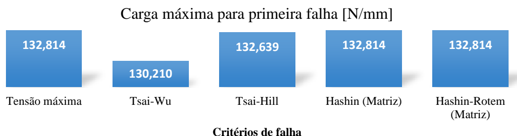
Figura 57 - Carga máxima obtida para primeira falha nos diversos critérios de falha do estudo E6
