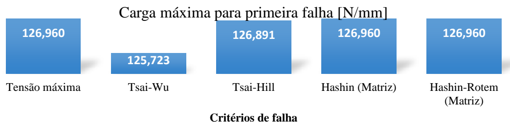
Figura 82 - Carga máxima obtida para primeira falha nos diversos critérios de falha do estudo E8
