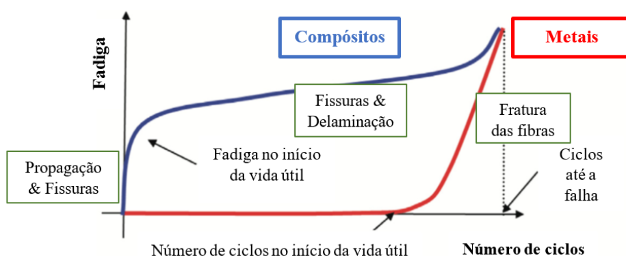
Figura 15 - Gráfico da evolução da fadiga versus número de ciclos nos materiais compósitos e metálico, baseado em (Jollivet et al. 2013) e (Rubiella et al. 2018)
