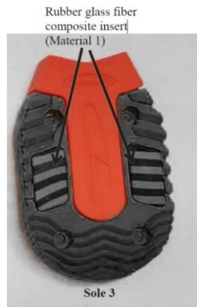
Figura 17 - Solas de botas de Ski reforçadas com borrachas em compósitos reforçados com fibras de vidro, (Colonna et al. 2016)
