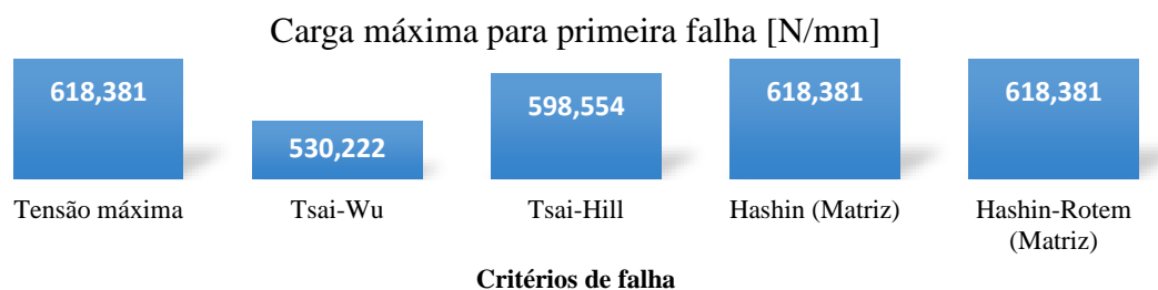
Figura 65 - Carga máxima obtida para primeira falha nos diversos critérios de falha do estudo E10
