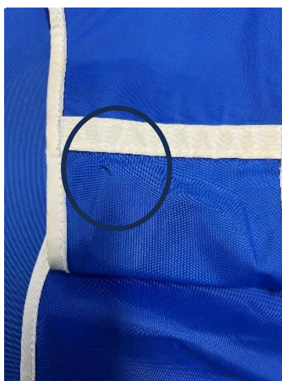
Figura 4.21: Representação de furo visível.
