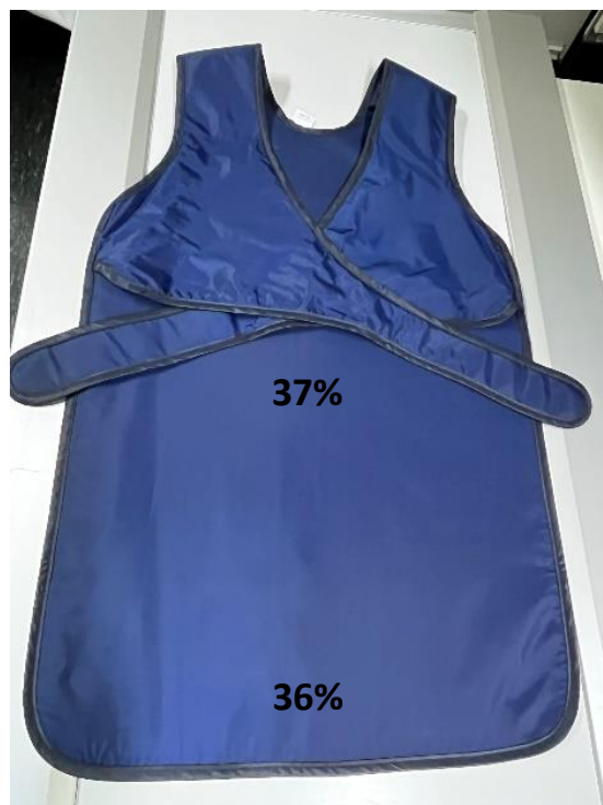
Figura 4.29: Percentagem segundo a localização dos danos.
