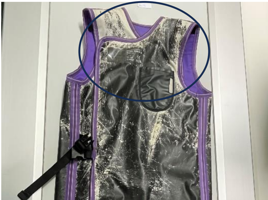
Figura 4.19: Representação de dano na película externa.
