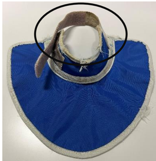
Figura 4.22: Colar protetor de tiroide com danos nas bainhas e sujidade na bainha superior.
