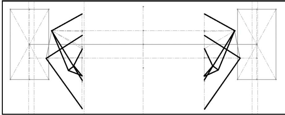
Figura 43 - Primeira versão da suspensão da traseira do sistema Pull-Rod
